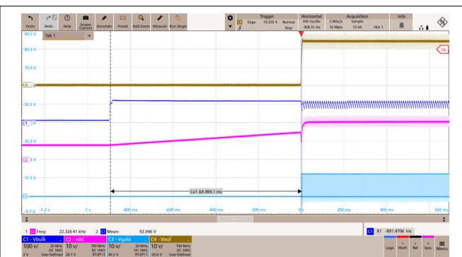
图 8-5. 85Vac 和满载条件下的启动波形
