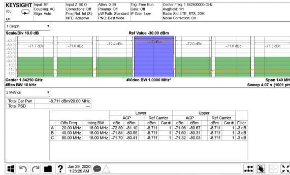
图 4-68. TX 20-MHz LTE Output Spectrum at 1.8425GHz
