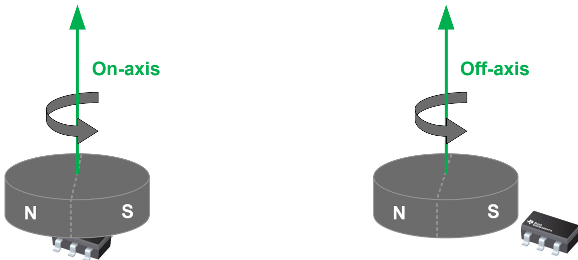
图 7-19. 同轴角度测量与离轴角度测量
