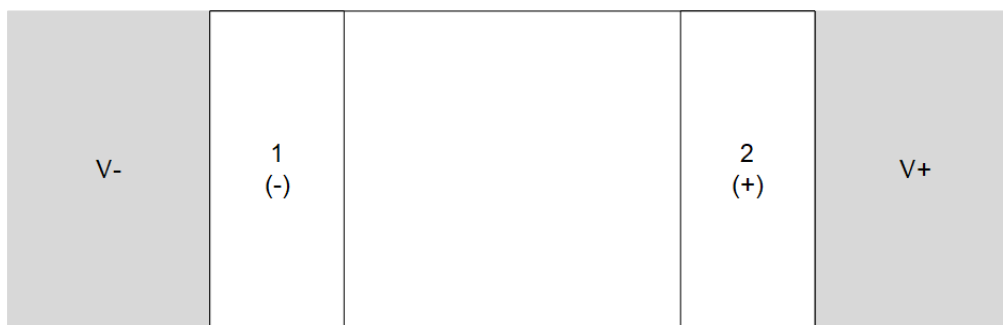
图 11-1. 建议布局：DEC 封装
