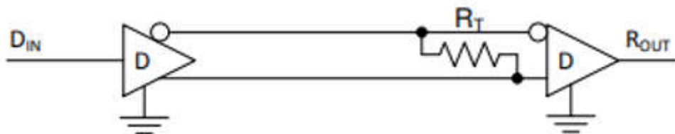
图 8-1. 具有端接接收器的典型 RS-485 或 RS-422 应用。
